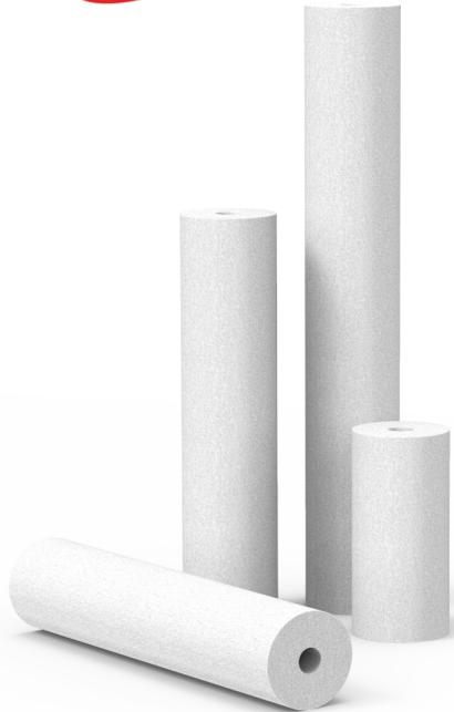
AX-BB Filterelemente werden aus reinen Polypropylenmikrofasern hergestellt, die im Melt-Blown-Verfahren thermisch gebunden werden. Durch ihren größeren Außendurchmesser, im Vergleich zu Standardelementen, haben AX-BB Elemente eine höhere Durchflussrate und eine größere Schmutzaufnahmekapazität.
